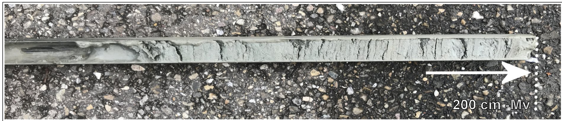
Figuur 17: Spijk, Alberdaweg 9: Foto van de gutssteek (met een 3 cm guts) van boring 5 met onder de geroerde toplaag (niet zichtbaar op de foto) de getijden-afzettingen. Dit pakket bestaat uit sterk tot uiterst siltig zand met veel dunne kleilagen. De rechterzijde van de guts op de afbeelding is de onderkant van de gutsboor (200 cm beneden maaiveld). Op de foto is het opgeboorde sediment in de gutsboor afgebeeld tot op een diepte van circa 200 cm beneden maaiveld. De bovendiepte bedraagt 140 cm beneden maaiveld.
