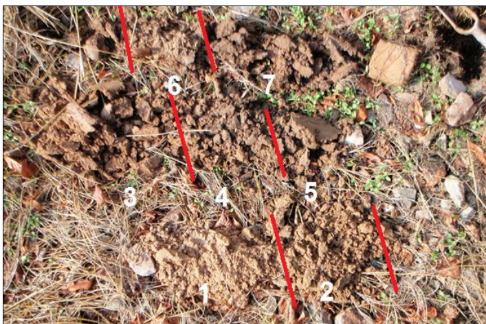
Afbeelding 18. Foto van boring 2, rechtsboven de top en linksonder de onderkant van de boring. 1: matig grof zand, 2: zeer fijn zand, 3: zwak tot sterk zandige klei, 4: zand, matig siltig, 5: klei, sterk zandig, 6: zand, matig grof, 7: klei, sterk zandig, bouwvoor
