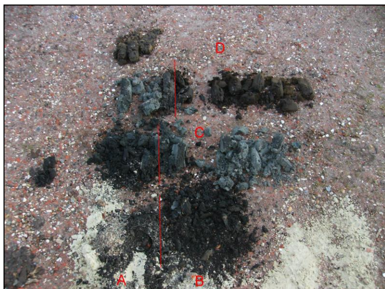
Afbeelding 8: Beeld van boring 39 (de boring is van linksonder naar rechtsboven uitgelegd). A: verstoorde/opgebrachte laag voor de verharding, B: sterk humeus zand met puinresten, C: sterk zandige klei, D: B-horizont in het dekzand die overgaat in de BC-horizont.
