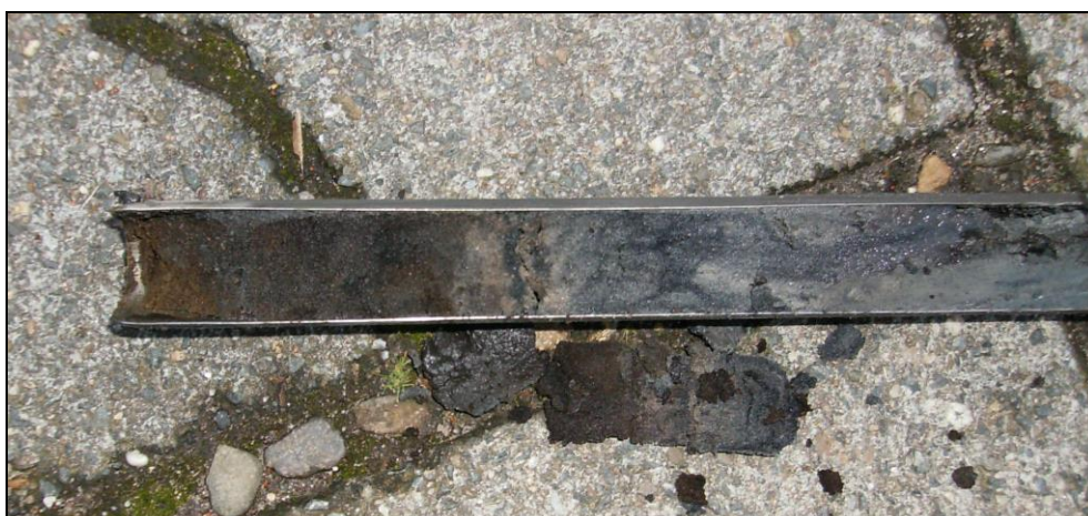
Afbeelding 10: Boring 10 waarbij net boven de donkerbruine podzollaag een verstoorde overgang naar het kleipakket zichtbaar is.
