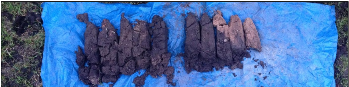
Boring 3: 0-100 cm -Mv. Gestaakt in grind, materiaal loopt uit boor.
