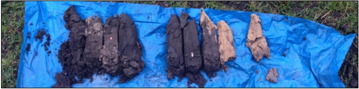
Boring 5: 0-110 cm -Mv. Materiaal loopt uit boor.
