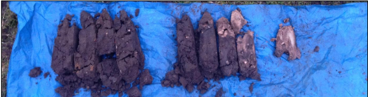
Boring 2: 0-110 cm -Mv. Gestaakt in grind, materiaal loopt uit boor.
