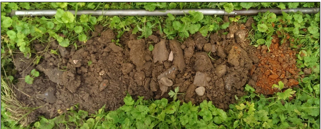
Figuur 12: Zicht op boring 3, uitgelegd van links naar rechts. In het midden zicht op de donkerbruine zandige leem met grind, baksteenpuin, mergelgruis, vuursteen en aardewerk. Geheel rechts in beeld het opgeboorde baksteen, waardoor de boring is gestaakt op 82 cm –mv.
