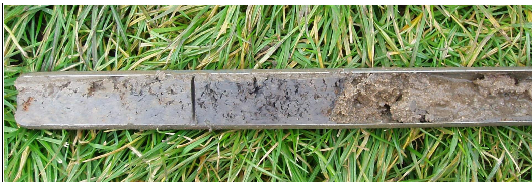
Figuur 7: IJsselstein, Achtersloot 89A: monster boring 5 van 70 tot 100 centimeter beneden maaiveld. In het midden is een donkergrijs vegetatieniveau in de klei aanwezig. Links daarvan de onderliggende lichtgrijze klei. Rechts de verstoorde bovengrond die bestaat uit aangevoerd zand.
