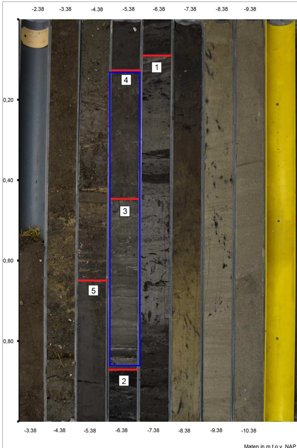
Afbeelding 11: Begemann boring 1 van locatie De Green/Homeruspark met in het blauwe kader de vermoedelijke sedimenten van het Hauwert Complex.
