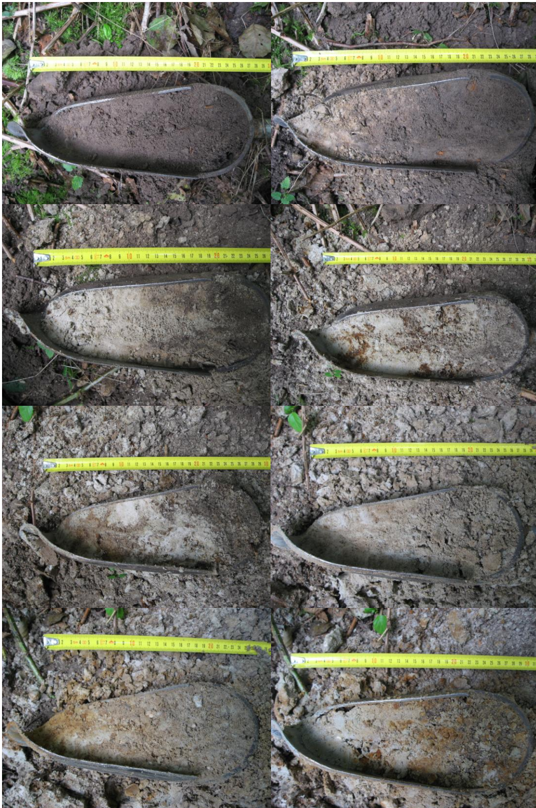
Afbeelding 14: foto1; 0-20 cm –mv Ap, Foto 2; 30-40 cm –mv overgang A- naar C-horizont, Foto 3; 50-60 cm C-horizont, Foto 4; 70-80 cm –mv met roest en ijzerconcreties, Foto 5; 80-90 cm –mv, met roest, Foto6; 90-100 cm –mv grijs zand met iets roest, Foto 7; 130-140 cm –mv overgang naar sterk roestig zand, Foto 8; 160-170; overgang van sterk roestig naar lichtgrijs sterk grindig zand.
