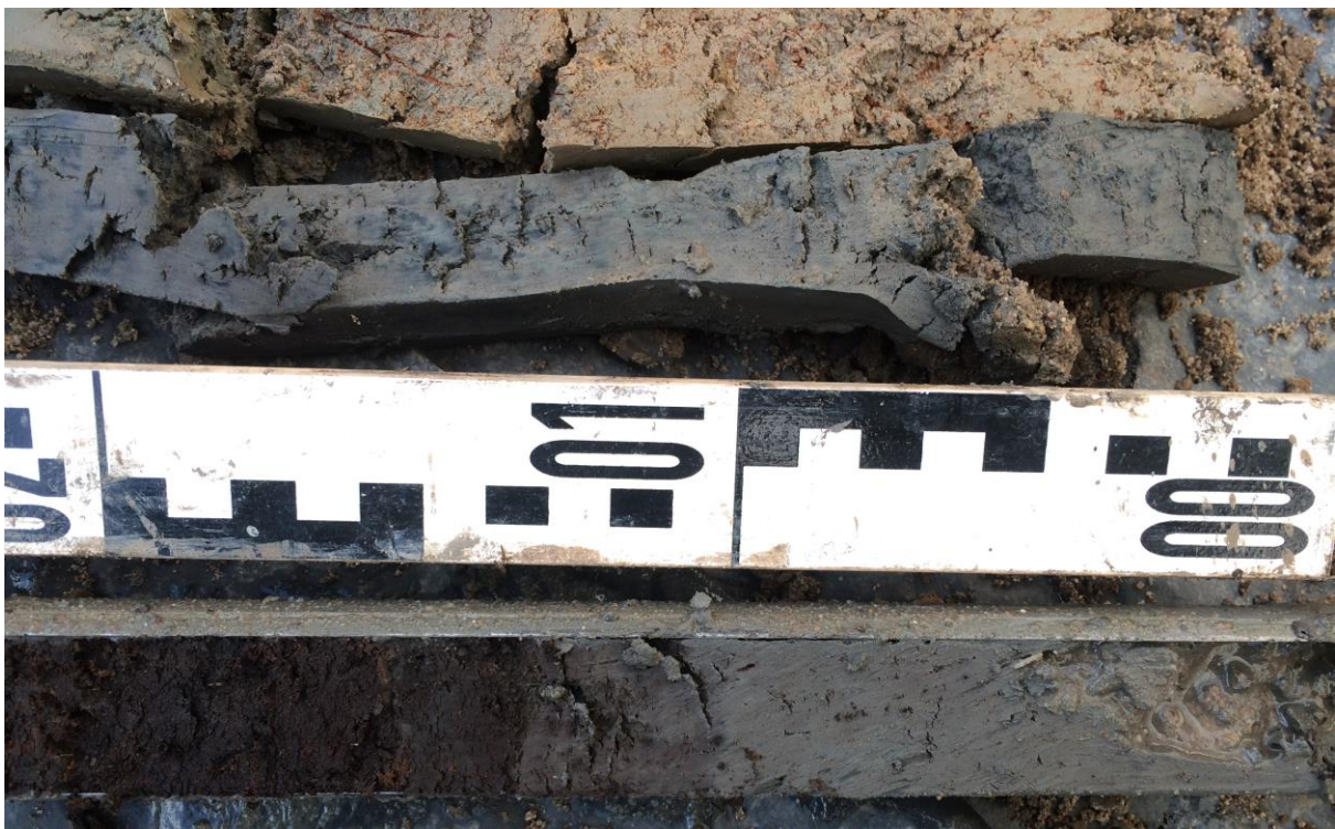
Boring 6: detailopname boorkernen met in onderste gutsboorkern de overgang van de Duinkerke I naar het Hollandveen op 214 cm –Mv
