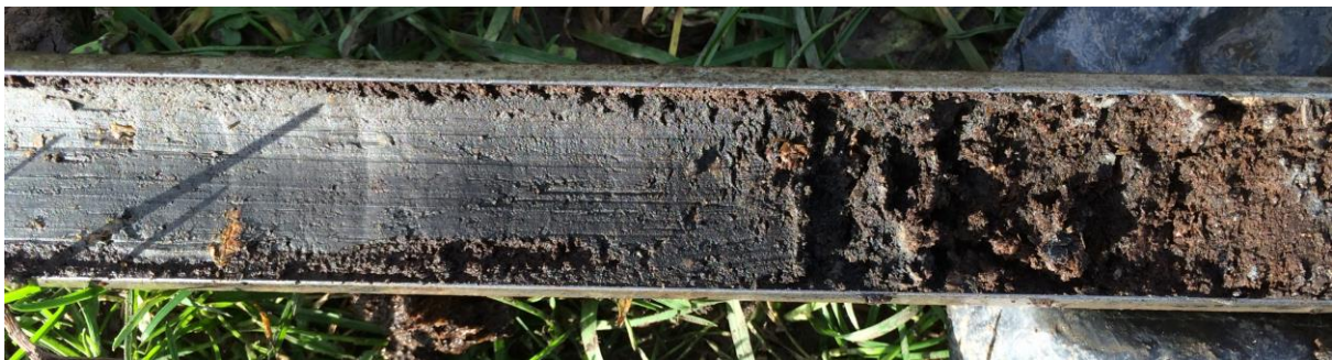
Boring 3: Calais-afzettingen met in de top een laklaag als gevolg van inspoeling van humuszuren uit het bovenliggende Hollandveen (382-400 cm –Mv)
