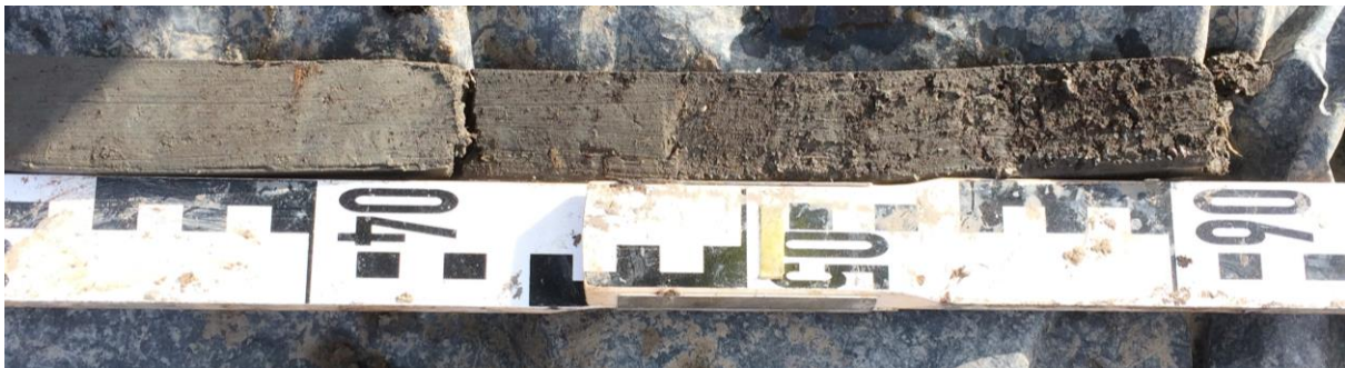
Boring 3: warven-achtige zonering in Duinkerke I-klei in de vorm van zones met een bijmenging van humeuze stof/fijne fractie; tussen 147 en 256 cm –Mv
