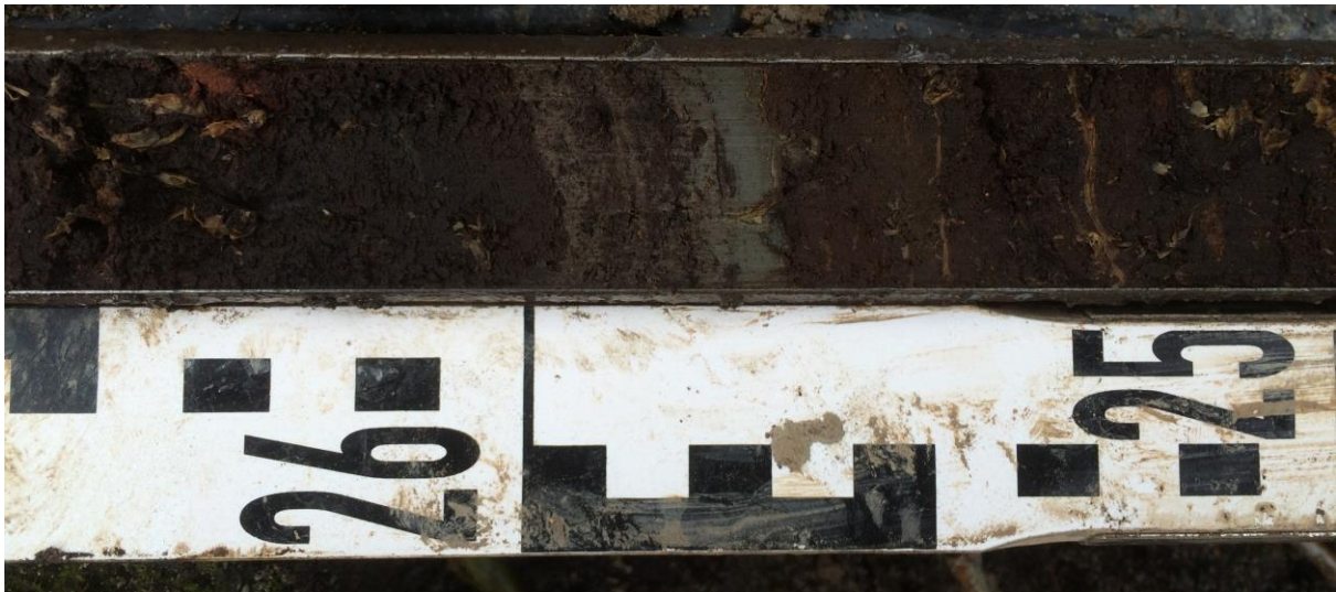
Boring 2: dunne Duinkerke-inschakeling in het Hollandveen op 257-259 cm -Mv
