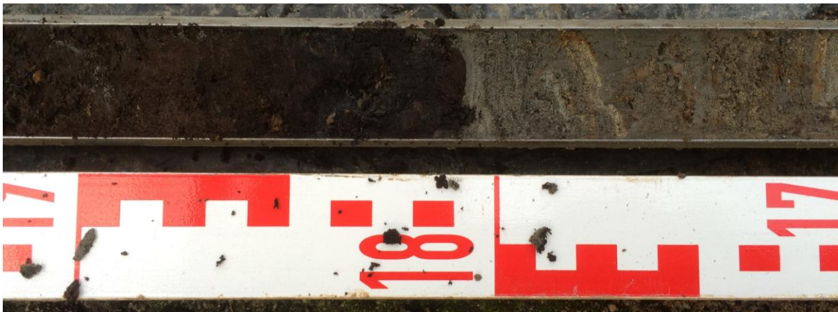
Boring 1: erosieve overgang zandige Duinkerke I-afzettingen naar Hollandveen op 145 cm -Mv
