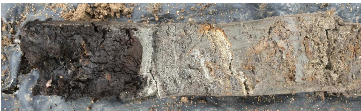
Boring 2: erosieve overgang zandige Duinkerke I-afzettingen naar Hollandveen op 185 cm -Mv
