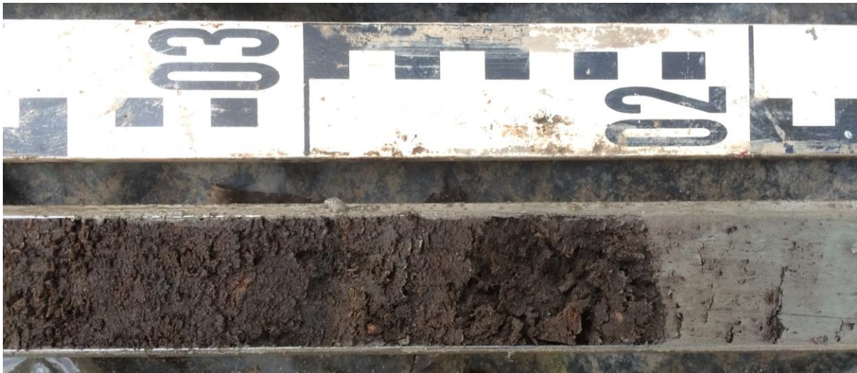
Boring 7: overgang van de Duinkerke I naar het Hollandveen op 222 cm –Mv. Duidelijk is te zien dat hierbij de top van het Hollandveen is geërodeerd
