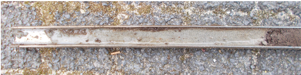
Figuur 8: Sassenheim, Hortusplein: Foto van het waterverzadigde strandwalzand dat onderin alle boringen is aangetroffen.
