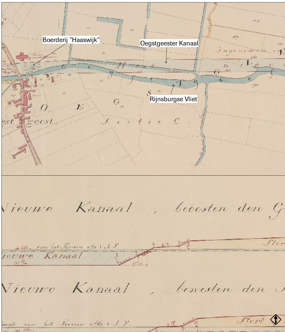
Afb.4 (Boven)Detail van de kaart van P.Kock uit 1840 ten oosten van de oude dorpskern van Oegstgeest. Hierop is de loop van de Rijsburgse Vliet weergegeven ten opzichte van het nieuw gegraven Oegstgeester Kanaal. (Onder) Een dwarsdoorsnede van het kanaal. Hierbij is te zien dat de oevers van het kanaal met een hoek van 30° is ingegraven.
