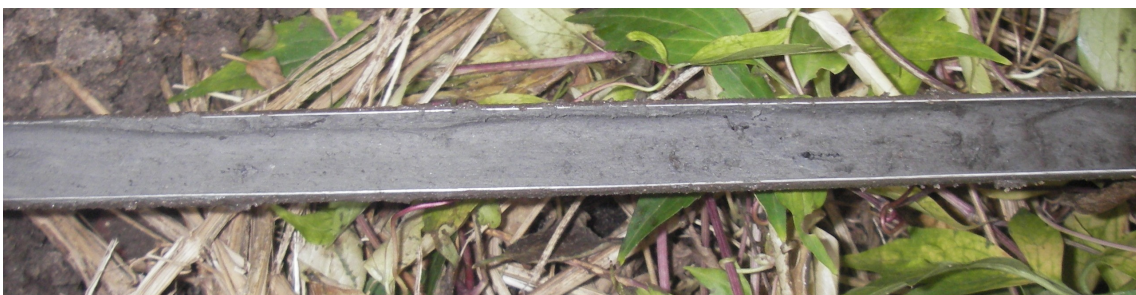
Figuur 7. Bodegraven, Noordstraat 45. De overgang van door zandlaagjes onderbroken klei (links) naar zwak venige klei (rechts) zoals deze in boring 2 is aangetroffen.
