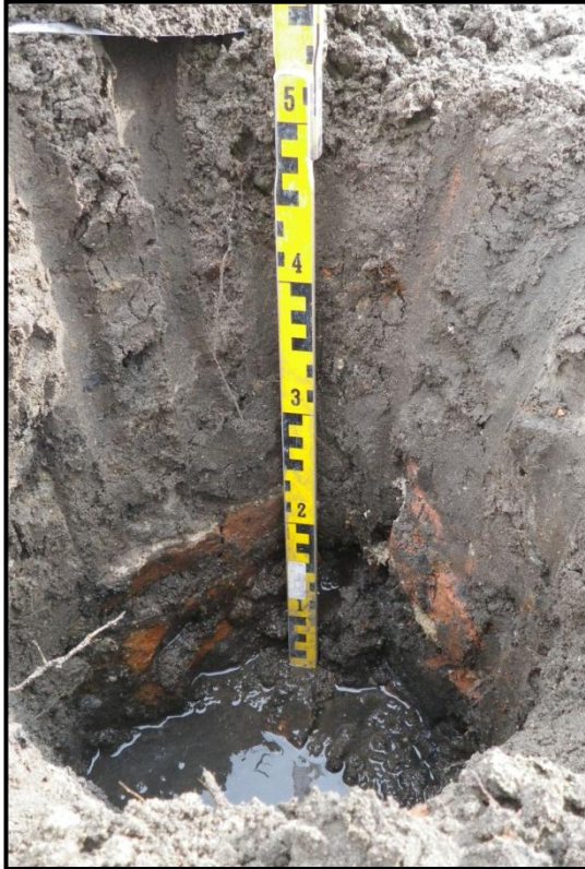
Figuur 5. Foto van het gegraven gat bij boring 4. Zichtbaar zijn de bakstenen van de gemetselde afvoer.
