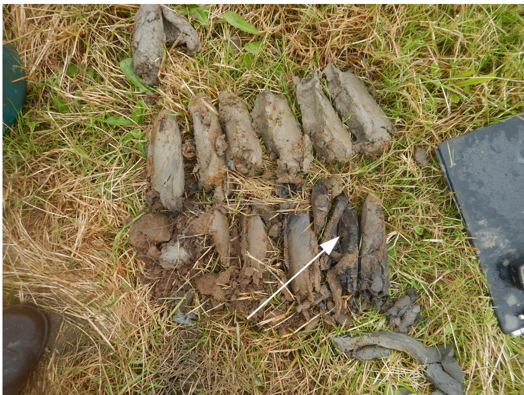
Figuur 19: Foto van boorprofiel 86 met de zwartgrijze laklaag (bij witte pijl) op 35-45 cm -mv in het plangebied.
