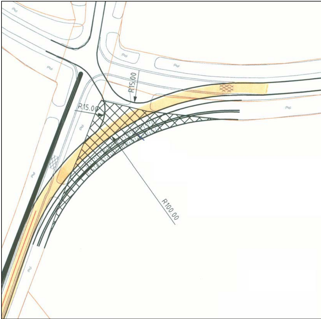
Afbeelding 5. Plankaart van de wegverlegging ter plaatse van het noordelijke deel van de Karwijweg. Schaal 1: 1.000.
