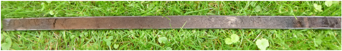
Figuur 10: Balk, Eastwâl: Podzolvorming zoals deze op de boorpunten 8, 9, 14 en 15 is aangetroffen. Links van het midden is de B-horizont te zien met geheel links, de BC-horizont. Rechts van het midden is de vernatte en doorwortelde top van het dekzand duidelijk herkenbaar aan de witte vlekken en zwakke gelaagdheid. Deze gelaagdheid is met name onder het geheel rechts zichtbare veen aanwezig.
