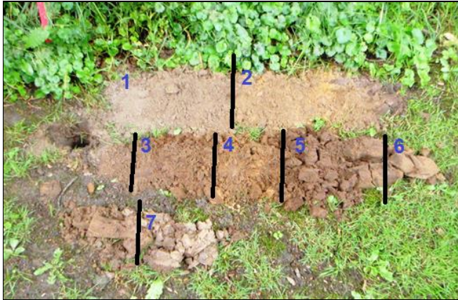
Afbeelding 10. Foto van boring 3 waarbij 1: bouwvoor, 2: opgebrachte grond, 3: B-horizont, 4: BC-horizont, 5: B-horizont, 6 en 7: C-horizont
