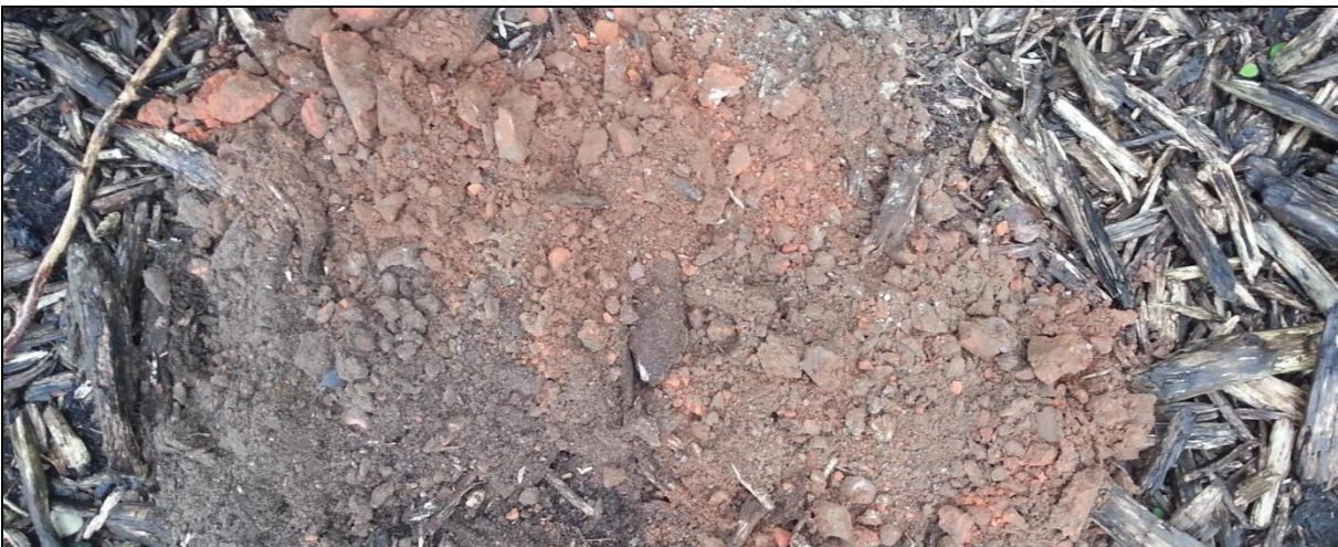
Figuur 9: Het profiel van boring 4. Zelfs in de groenstrook is een dik pakket baksteen en puin aanwezig.
