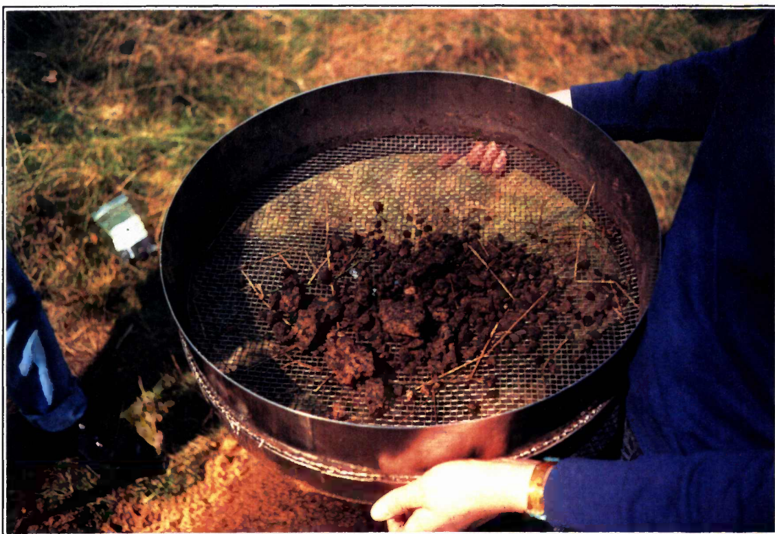
Figuur 4: het zeven van een opgeboord grondmonster.
