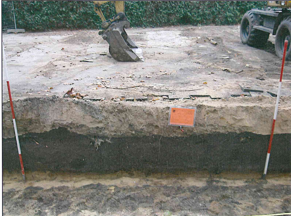
Afbeelding 2: Opbouw van het bodemprofiel
