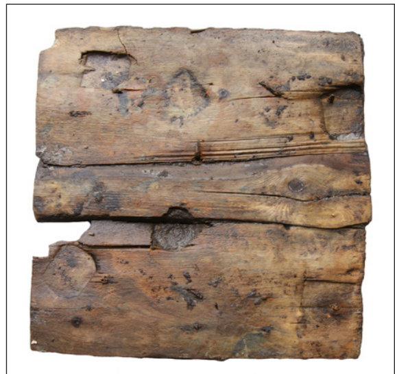
Afbeelding 28. Een vierkant stuk funderingshout van 40 bij 40 cm met een dikte van 5 cm (monster 6). De indrukken van de zes slieten waar het hout op lag zijn duidelijk zichtbaar.
