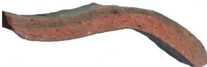
Profiel dakpan, V7 (niet op schaal)
