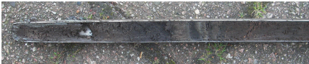
Figuur 5. Sneek, Zuidwesthoekweg 2. Foto van boring 4 met links de top van het dekzand, rechts daarvan kleilaagjes (de lichtgrijze bandjes) en geheel rechts veen.
