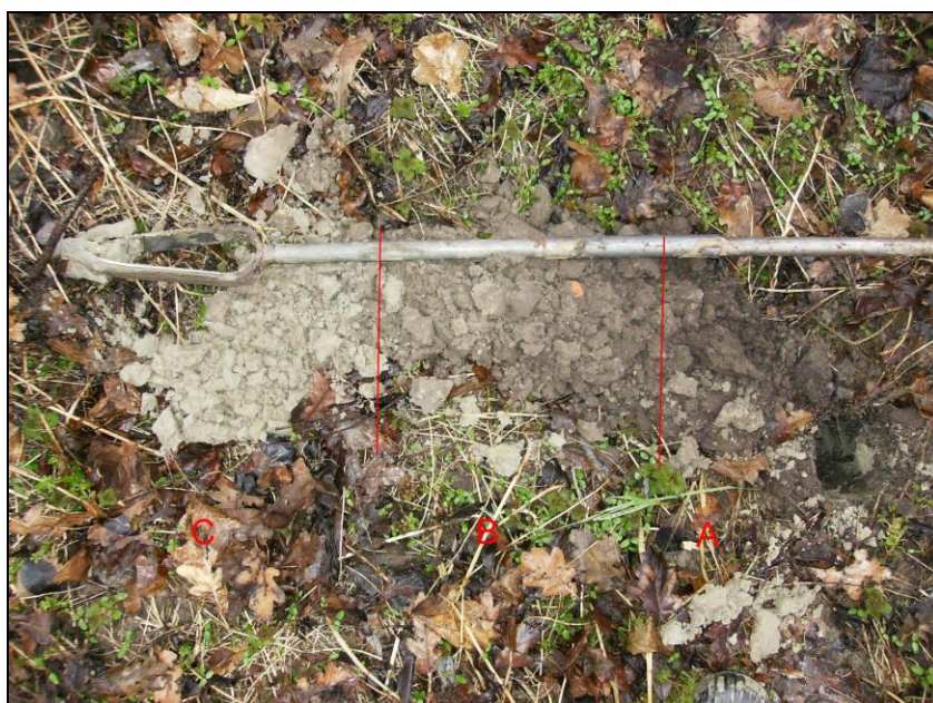
Afbeelding 8. Boring 3: waarbij A de bouwvoor is, B de overgangslaag met baksteen en C de natuurlijke ondergrond
