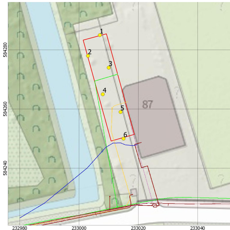
Figuur 8: Groningen, Iepenlaan 89: boorpuntenkaart. De genummerde punten zijn de locaties van de zes boringen. De rode lijn is de grens van het plangebied. De gekleurde lijnen zijn van leidingen. De Achtergrondkaart is van Opentopo via PDOK.
