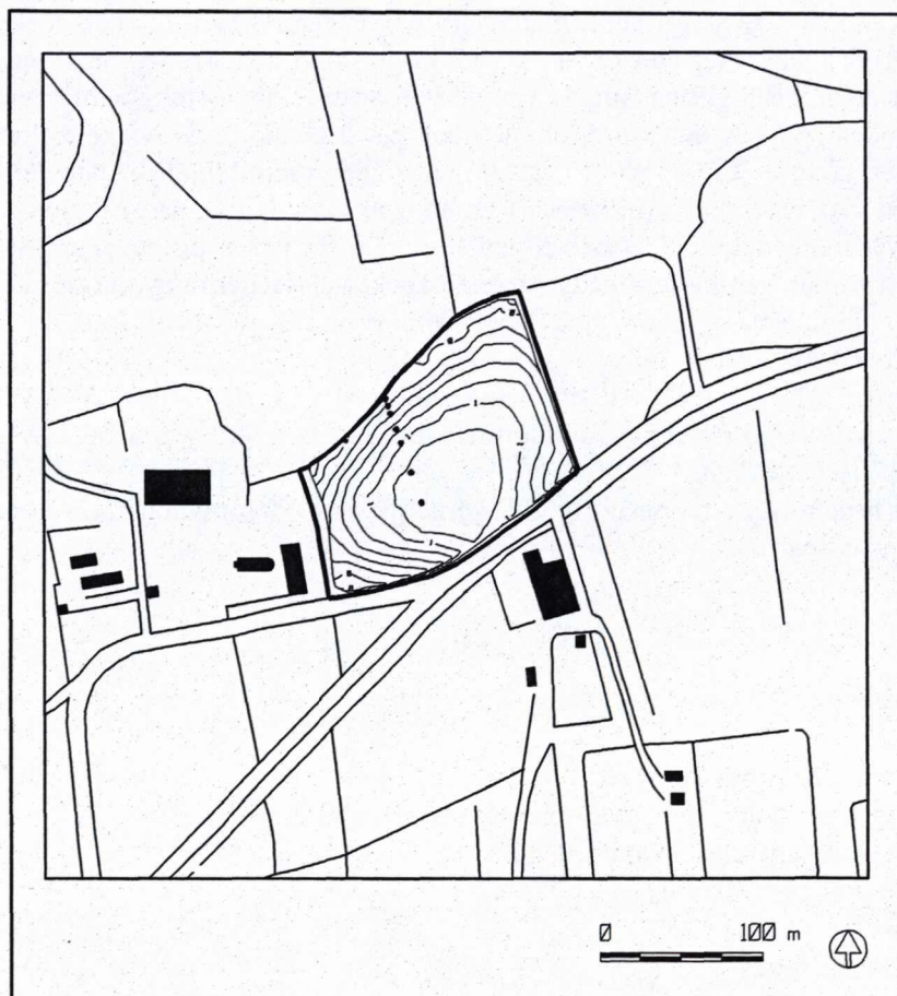
Figuur 37: Topografische situatie (opname 1979), de hoogtelijnen van AMF-terrein 5G-57 en de plaats van de boringen.
