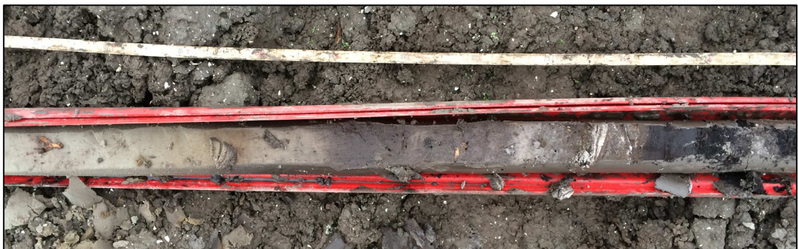
Figuur 7: De overgang tussen het veen en dekzand in boring 9. In de top is een een asgrijze E- en een zwarte/bruine B-horizont. Het veen erboven is erg los van structuur. Tevens zijn witte spoelzandlagen aanwezig.
