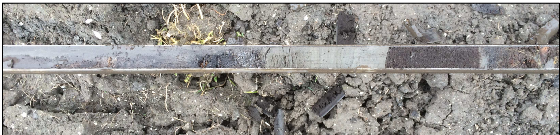
Figuur 6: Opname van Klappklei op de overgang van veen naar het dekzand (boring 218). Aan de basis van het dekzand is sprake van enige verspoeling getuige het geloogde zand daar. De klei is onderdeel van de Oude Getijdenafzettingen.
