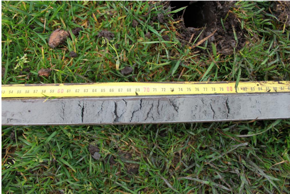
Figuur 6: Pakket met kleiige zandlaagjes in boring 15. De top van dit pakket ligt hier op 245 cm -mv (355 cm -NAP).
