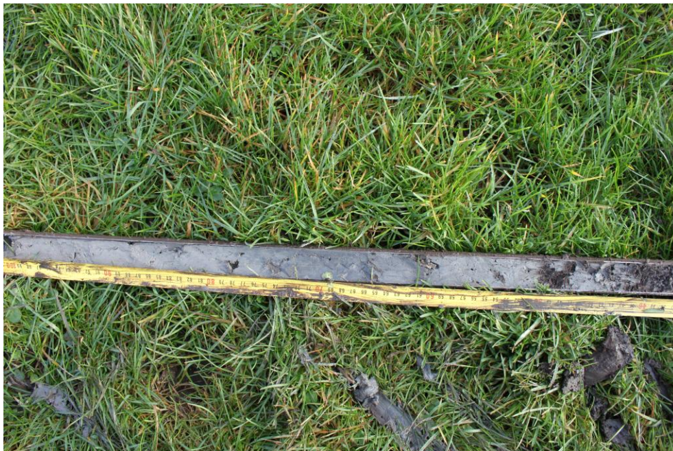
Figuur 5: Onder de onderste veenlaag in boring 3, bevindt zich in de slappe klei een laklaag. Laklagen zijn indicatief voor landschappelijke situaties waarbij het maaiveld net onder de waterspiegel ligt.
