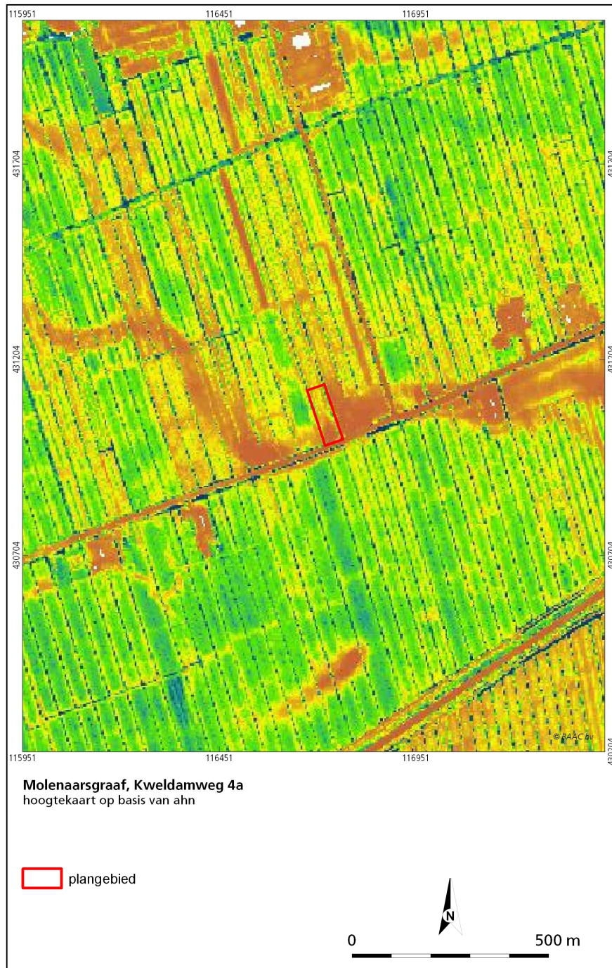
Figuur 2.2 Uitsnede hoogtekaart voor plangebied en omgeving. Oranje kleuren corresponderen met maaiveldhoogtes van circa -25 tot -125 centimeter +NAP, groene met circa -125 tot -150 centimeter -NAP en blauwe met circa -150 tot -175 centimeter +NAP.
