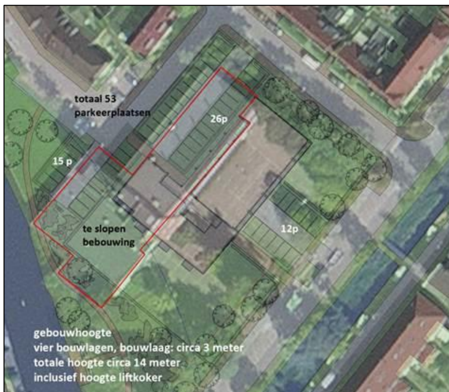
Afbeelding 3. Geplande bebouwing ten opzichte van het te slopen pand, dat hier middels een rood kader is aangegeven (bron: Rho adviseurs voor leefruimte)
