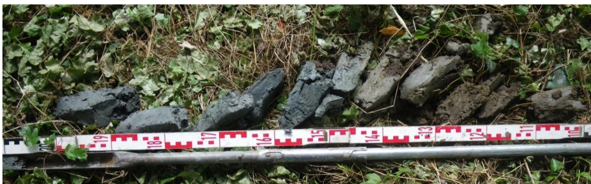
Abbeelding 12. Boorkern van boring 6 bestaande uit de lagen tussen 1 tot 2 m-mv. De overgang op 1,4 m-mv van lichtbruinrijze naar blauwgrijze klei is goed te zien. Boven de bruinrijze klei werd de puinhoudende, mogelijk middeleeuwse laag, gevonden.
