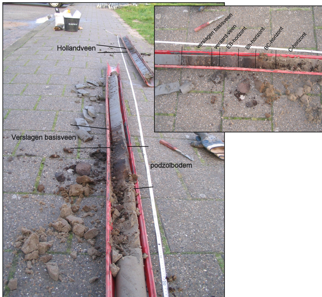
Figuur 3.1 De staande foto toont een overzicht van boring 4. De inzet betreft een detail van de bodem in de pleistocene ondergrond.
