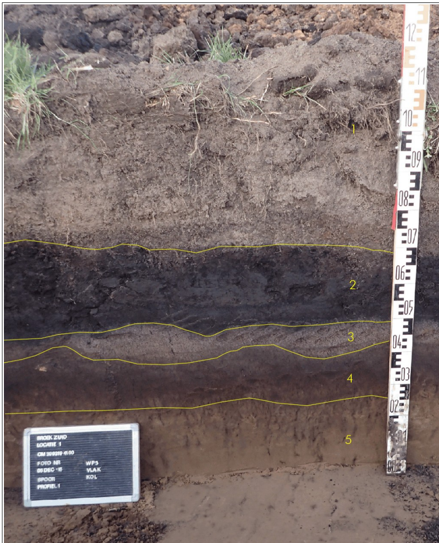
Figuur 6. Joure, Broek-Zuid: Het profiel van proefsleuf 3, van boven naar onder bestaande uit (1) een bouwvoor bestaande uit sterk zandige klei, (2) een pakket gelaagd en sterk veraard veen, (3) een grijze E-horizont (uitspoelingslaag), (4) een bruine B-horizont (inspoelingslaag) en (5) de C-horizont, het schone dekzand. Foto genomen in noordelijke richting.
