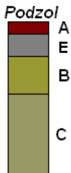
Afbeelding 3. Schematische weergave van een podzolbodem
