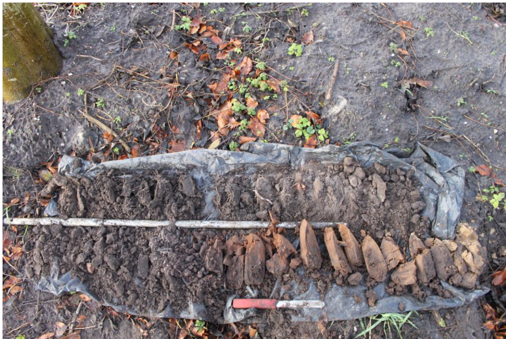
Figuur 7: Boring 1. Onder een opgebracht pakket bevindt zich het pleistocene substraat, met een B-horizont.
