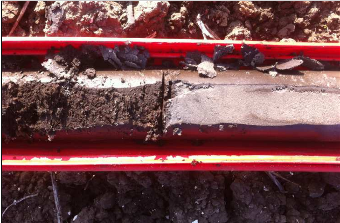
Figuur 6: Een haarscherpe, erosieve overgang tussen (detritus)veen (bruin, links) en het dekzand (geelgrijs, rechts) in boring 3. Sporen van enige bodemvorming ontbreken.
