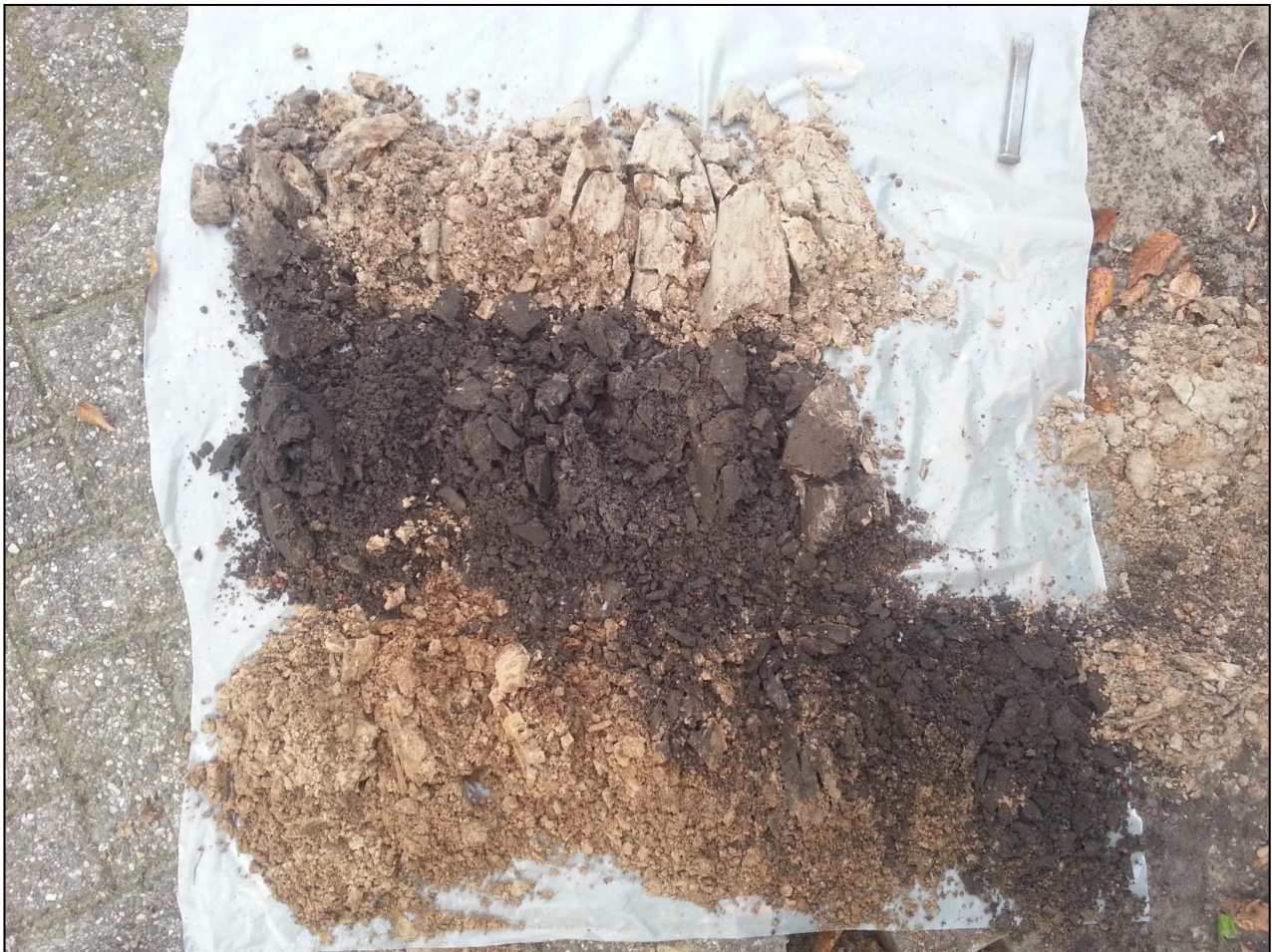
Figuur 9: Profiel van boring 2 waarin op 65 cm-mv een metaaltje werd aangetroffen. De leesrichting is van linksboven naar rechtsonder.
