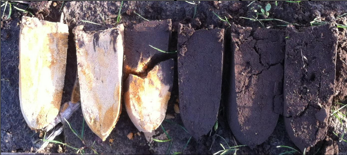
Figuur 4: Boring 004 van een zogenaamd AC-profiel
