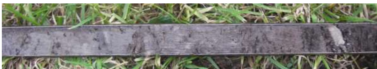
Figuur 12: Foto van boring 5 met de venige klei die een zeer geleidelijke overgang vormt tussen veen en onderliggende klei.
