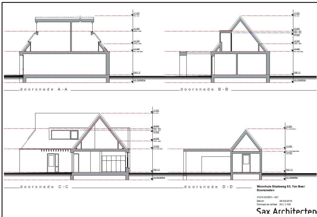
Afb. 4. Het plangebied met doorsneden van nieuwbouw. Nieuwe fundering wordt aangelegd op 1 m -mv. (rode lijn (bron: Sax Architecten 2019)).
