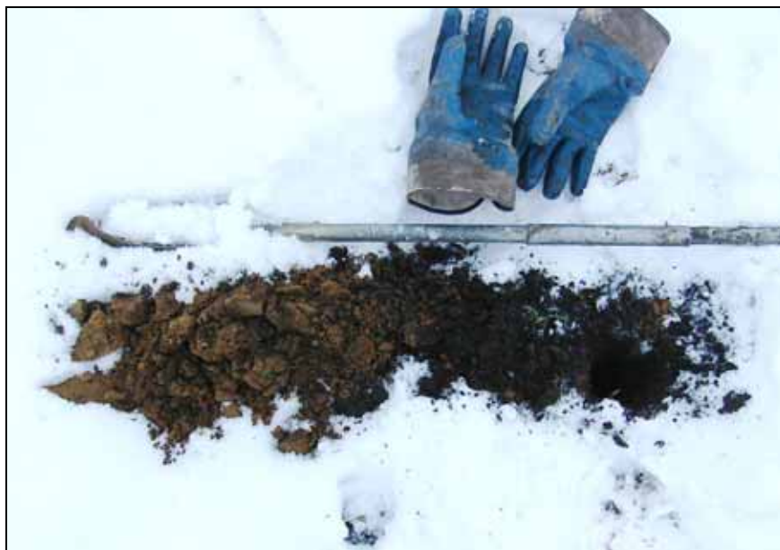
Afbeelding 7. Beeld van boring 1, met onder de handschoenen de bouwvoor die (naar links) scherp overgaat in het gele pleistocene dekzand.
