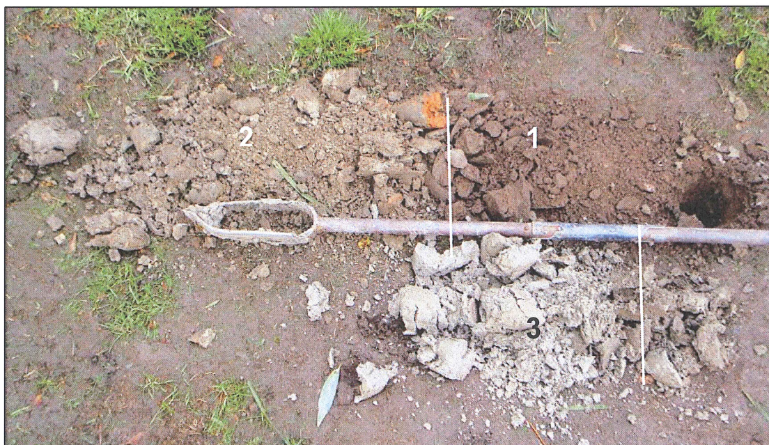
Afbeelding 3. Beeld van boring 5 met bij 1. bouwvoor, 2. wierdelaag, 3. kwelderafzettingen
