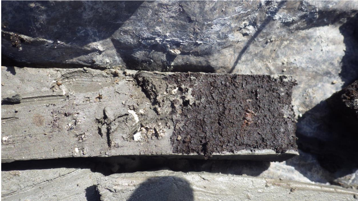
Boring 8: concentratie schelpfragmenten met kokkelachtige schelpen op circa 375-380 cm –Mv. Deze getijdenafzettingen gaan via een scherpe laaggrens over in Hollandveen.
