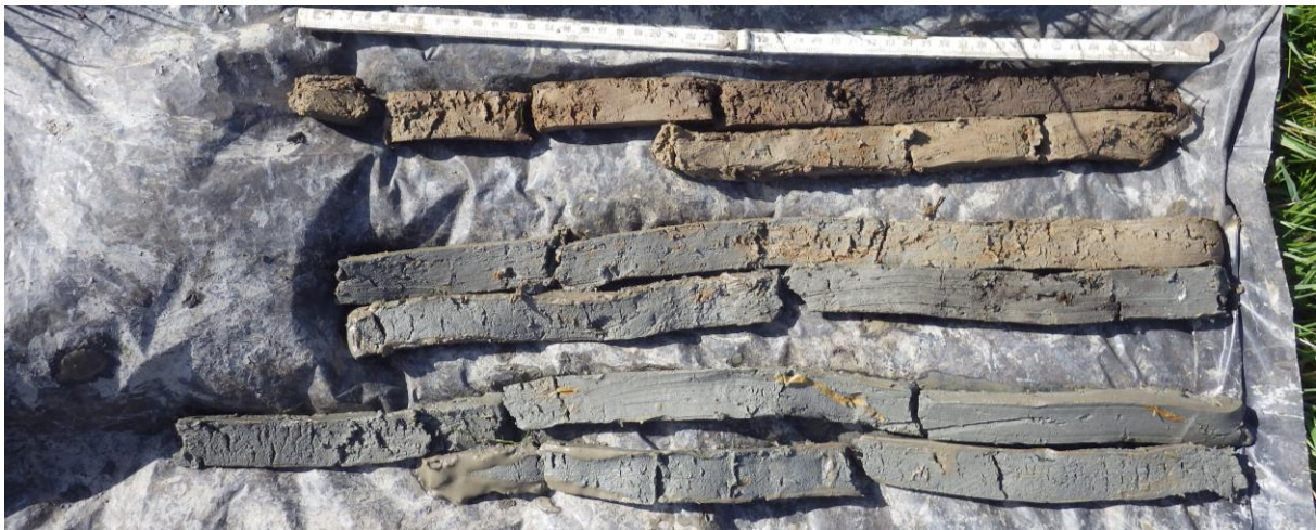
Boring 9: totaaloverzicht boorkernen
