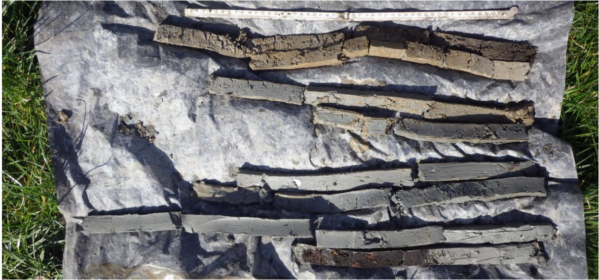
Boring 8: totaaloverzicht boorkernen
