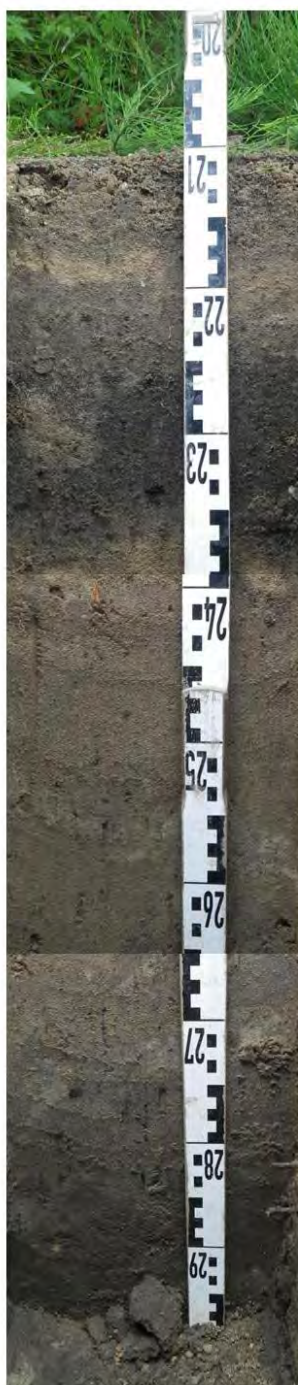
Figuur 4: compositiefoto van de bodemopbouw van het ophoogpakket bij boring 9.
