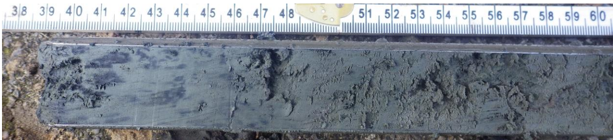
Boring 1: detail overgang zandige blauwgrijze terplaag met fosfaatvlekken naar matig zandige blauwgrijze kwelderklei met zwarte vegetatievlekjes van waarschijnlijk verspoeld organisch materiaal.
