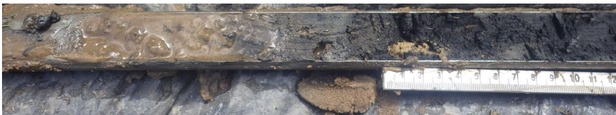
Boring 4: overgang van ophoogzand naar een terplaag op 100-120 cm –Mv. Dit niveau is sterk humeus, bijna zwart van kleur, matig slap en bevat brokjes rood baksteen/aardewerk en kalkmortel.
