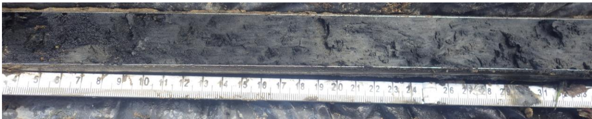
Boring 4: overgang van de sterk humeuze terplaag naar een sterk zandige licht-blauwgrijze klei met zwarte humeuze vlekjes van vermoedelijk verspoeld organisch materiaal (120-180 cm –Mv).
