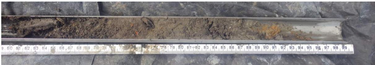
Boring 7: zwak humeuze, matig zandige klei met op 76 cm –Mv een scherfje handgevormd aardewerk (60-105 cm –Mv). Ook bevat deze lichte fosfaat-achtige vlekken en rood-oranje baksteen/aardewerk brokjes, kleine brokjes kalkmortel en houtskool; mogelijk in deze laag terecht gekomen als gevolg van bioturbatie of omzetting. Het betreft dus een antropogene ophogingslaag i.c. terplaag.
