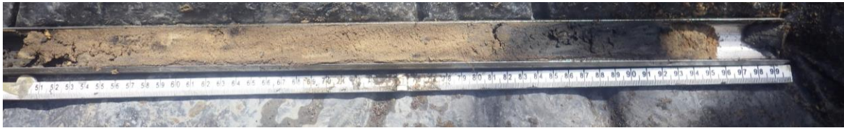
Boring 4: ophoogzand in de eerste meter.
