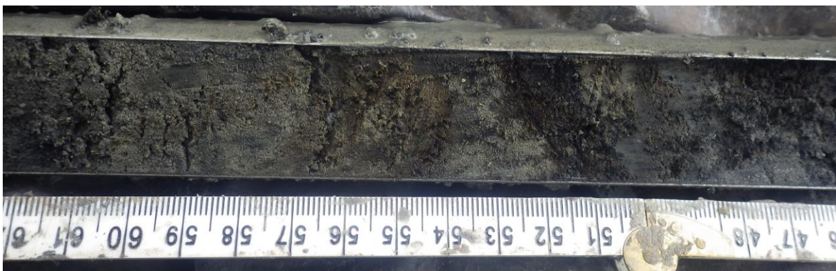
Boring 7: zwak humeuze sterk siltige kwelderafzettingen met brokjes klei en veen (252-330 cm –Mv).
