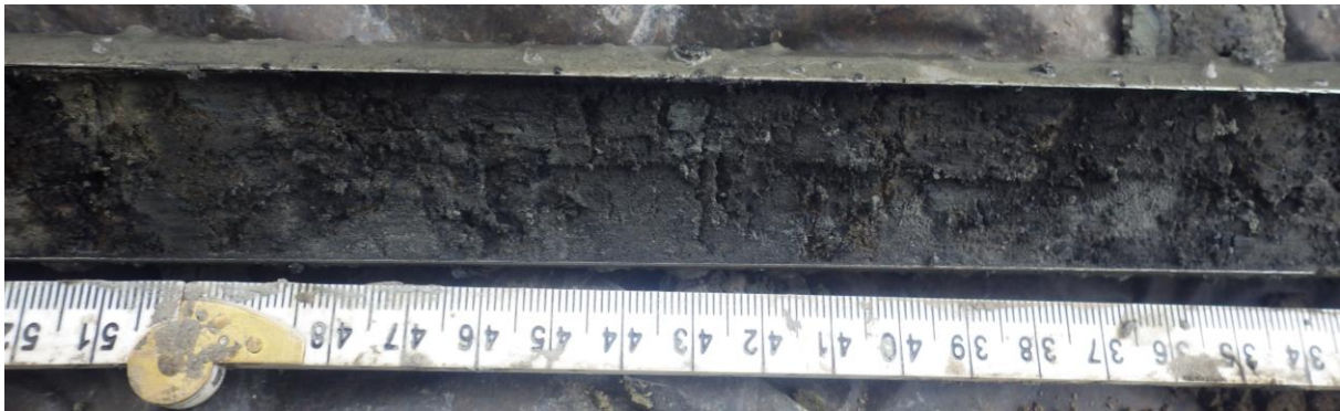
Boring 7: vegetatiehorizont van matig humeus, sterk siltig zand, met brokjes veen en fijn schelpgruis (224-252 cm –Mv).
