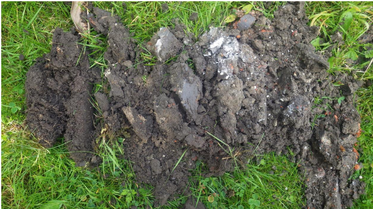
Boring 6: Als boring 5: sterk tot matig humeuze, sterk zandige klei met veel brokken rood baksteen en kalkmortel. Boring op 55 cm gestuit op waarschijnlijk een bakstenen muur.
