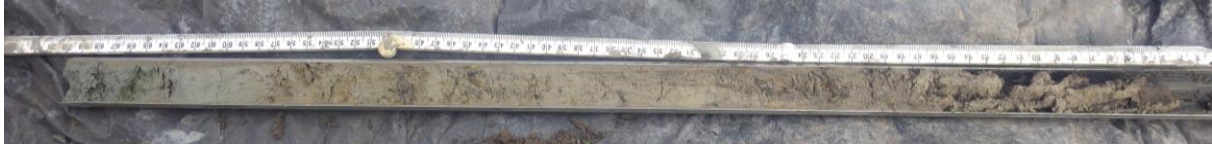
Boring 7: sterk zandige klei met roestvlekken op 105-130 cm –Mv.
