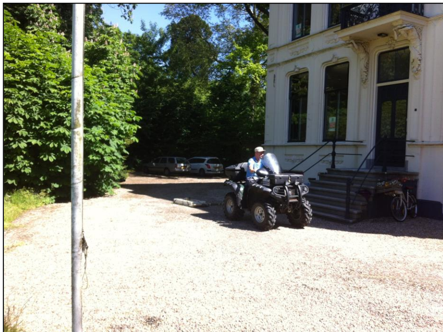
Figuur 12: Een grondradarmeting in het plangebied. De radar is daarbij achter een quad gemonteerd.
