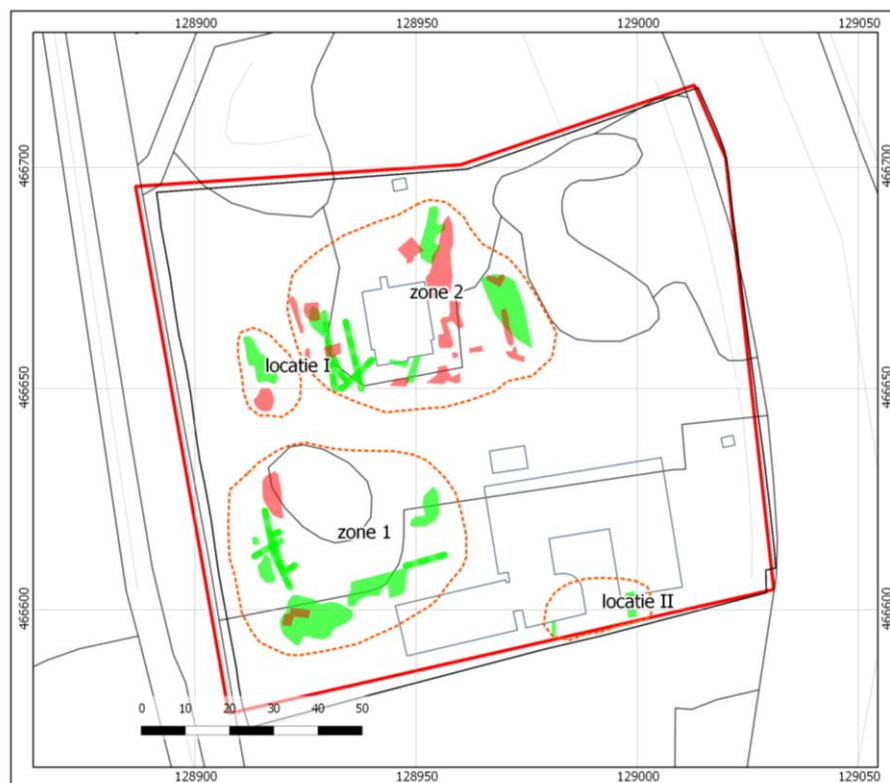
Figuur 14: Overzicht van de verschillende archeologische anomalieën in het plangebied, gesorteerd in zones en locaties. De groengekleurde anomalieën zijn afkomstig van de grondradar, de rode van de magnetometer.
