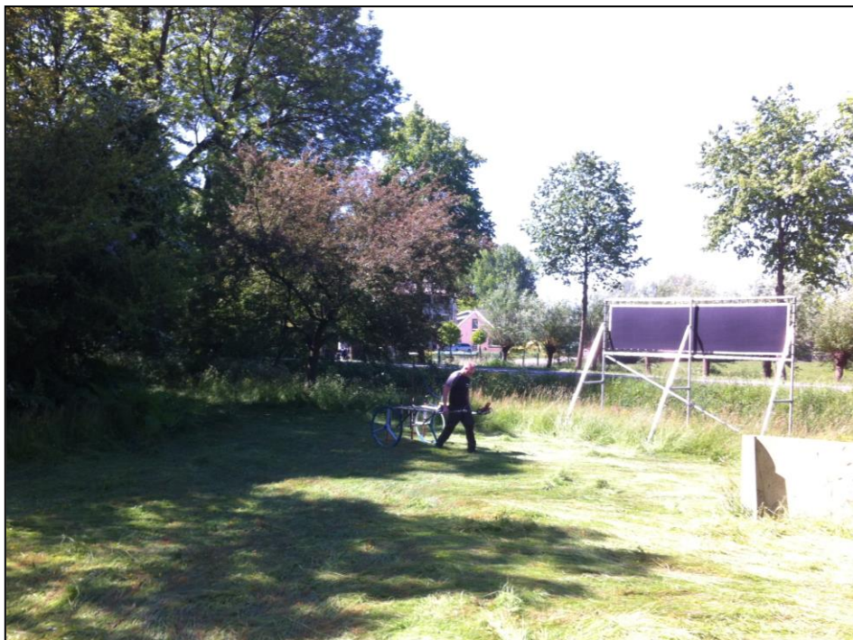
Figuur 13: Metingen met een magnetometer, handmatig voortgetrokken.
