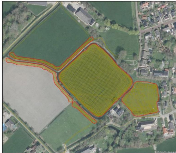
Figuur 5: overzicht van de uiteindelijk ingemeten radarlijnen in Sauwerd, aangegeven in geel.
