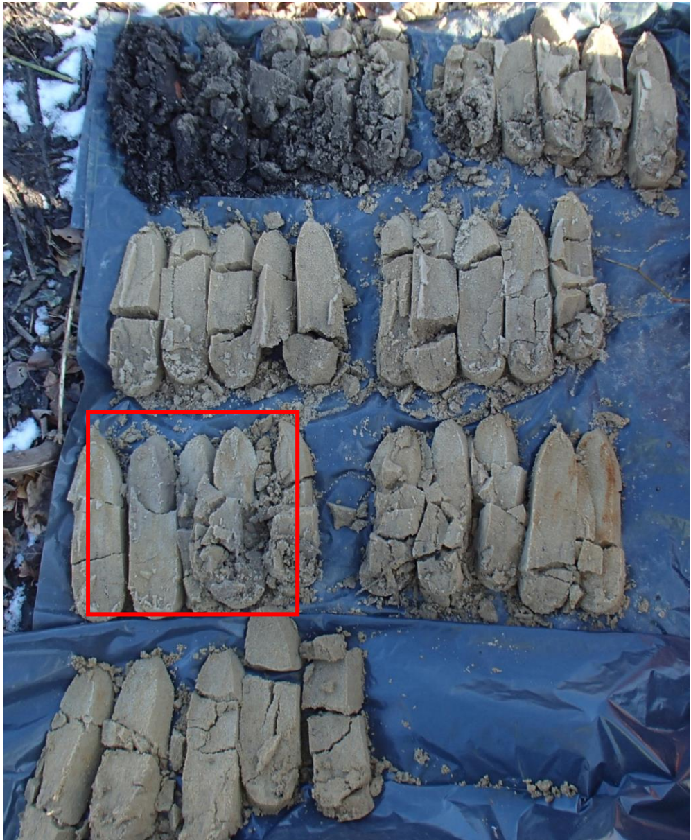
Boring 3: Overzicht boorkernen (uitgelegd van linksboven naar rechtsonder). Het bodemniveau bevindt zich in het rode kader.
