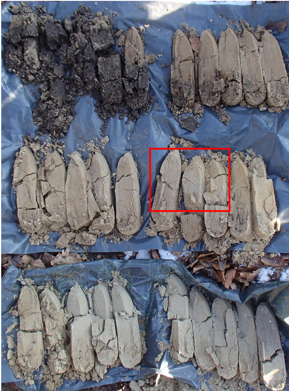
Boring 1: Overzicht boorkernen (uitgelegd van linksboven naar rechtsonder). Het bodemniveau bevindt zich in het rode kader.
