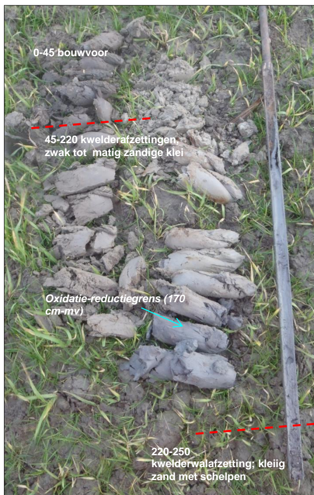
Abbeelding 9. Boring 4, representatief voor de bodemopbouw in de onderzoekslocatie. Leesrichting van boven naar beneden en van rechts naar links
