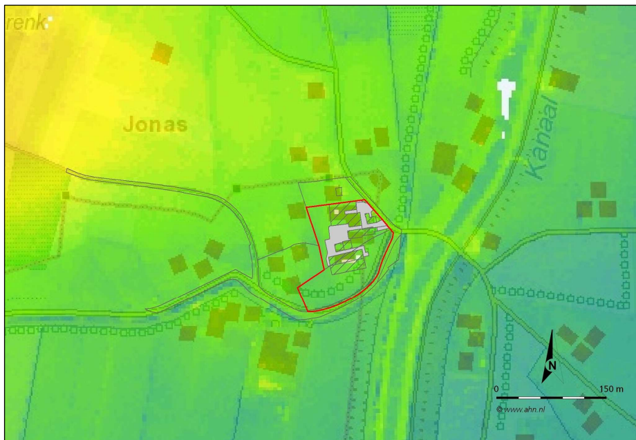
Figuur 2.2 Uitsnede van de AHN-viewer voor het plangebied en omgeving. 17 Het plangebied is middels een rood kader weergegeven. De bruine en gele tinten betreffen de hoger gelegen delen. De groene en donkergroene tinten vertegenwoordigen de lager gelegen terreinen.
