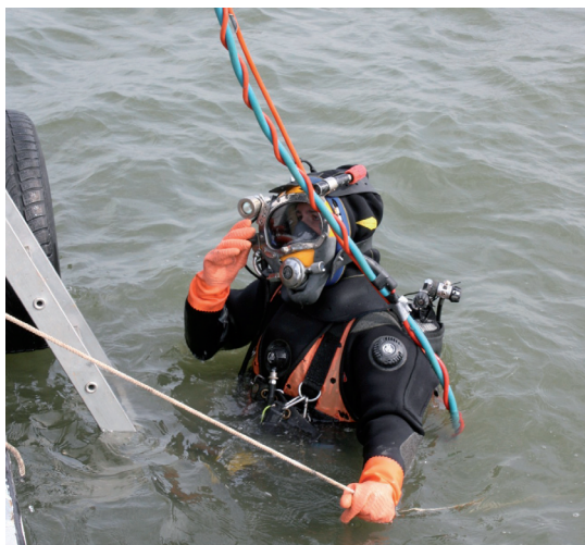
Afbeelding 4 Duiker met helm met video- en audioverbinding via umbilical.
